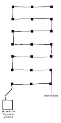
Рис. З Реализация применения микрофонной решетки для приема акустических сигналов
