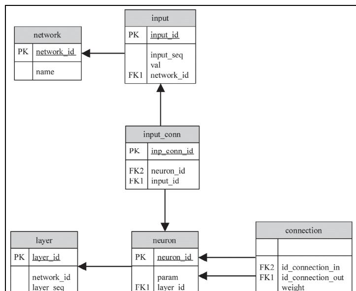
Рис. 4. Пример реляционной модели представления нейронной сети средствами реляционной СУБД
