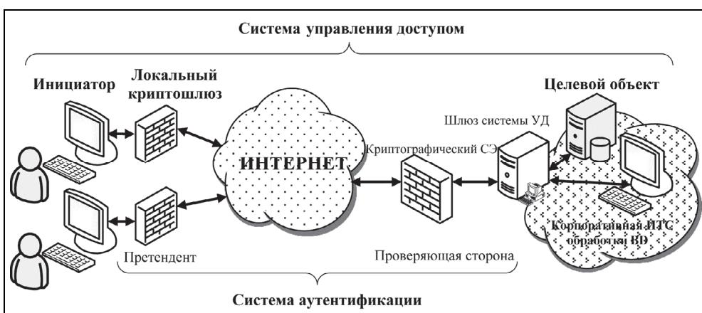
Рис. 7. Схема взаимодействия инициатора и СЭ
