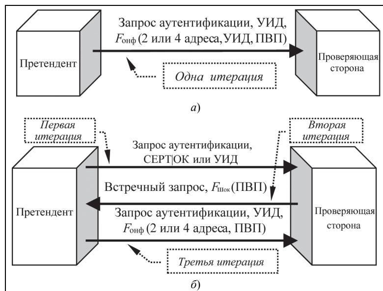
Рис. 8. Схемы 1-итерационной (а) и 3-итерационной (б) процедуры аутентификации
