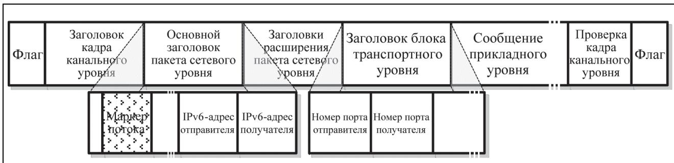
**Рис. 9.** Структура кадра канального уровня, поступившего на вход локального криптошлюза со стороны персонального компьютера инициатора запроса доступа
