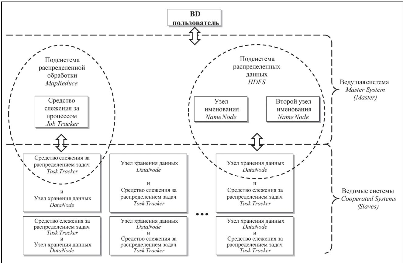
Рис. 2. Общая распределенная архитектура СОБД на основе КПО «Hadoop»
