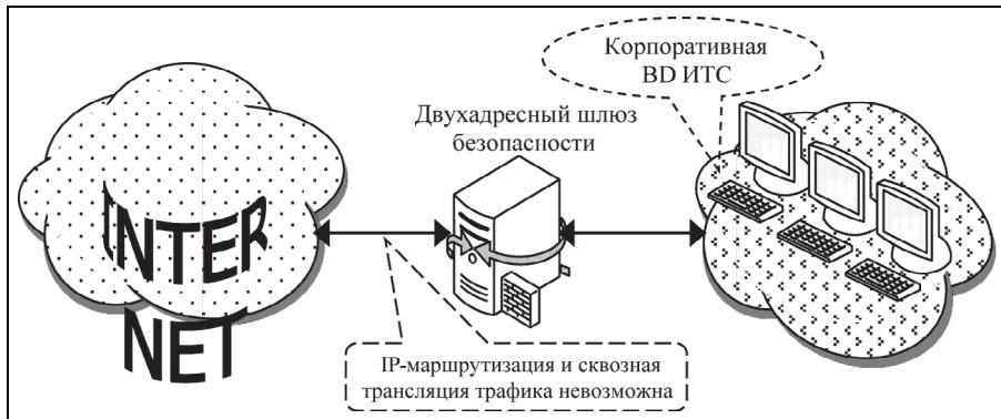
Рис. 4. Схема гибридного СЭ на основе двухадресного шлюза безопасности
