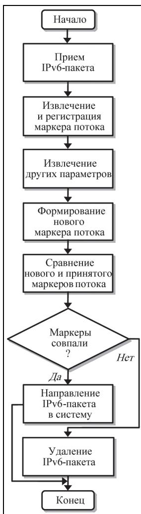
Рис. 6. Схема алгоритма проверки МП
